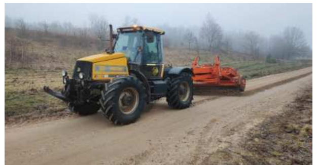
Kaltinėnų seniūnijos traktorius skirtas seniūnijos kelių priežiūrai: sniego valymui, kelių greideravimui, pakelių šienavimui.
